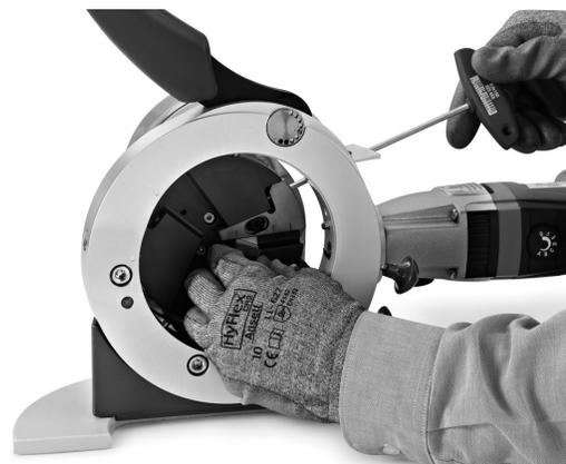
Abb. 7 Montage des Schneidwerkzeughalters
