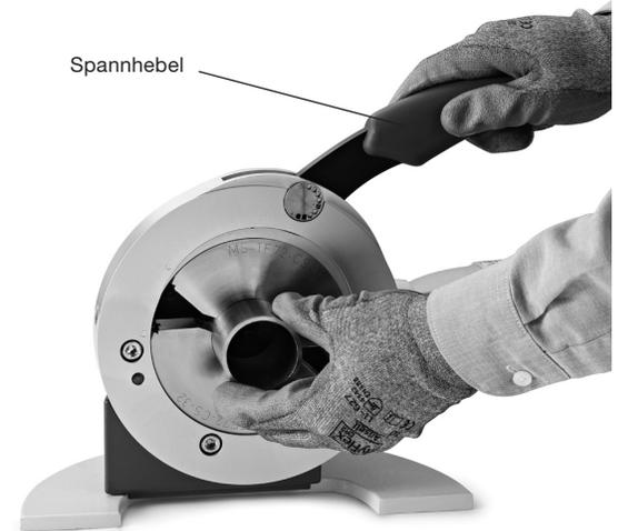
Abb. 14 Einspannen des Rohrs
