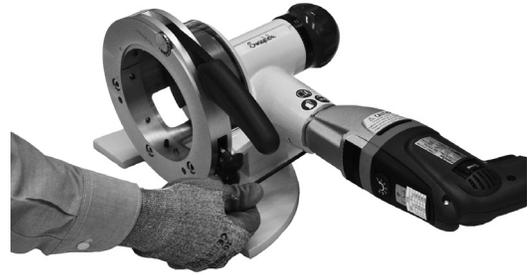
Abb. 16 Lösen der Stellschraube
