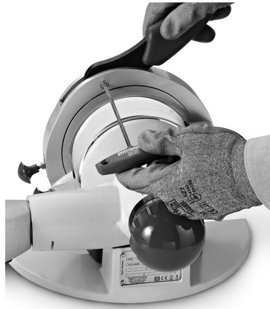
Abb. 13 Lösen der Inbusschraube
