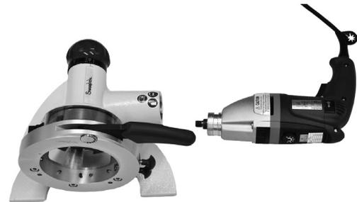
Abb. 17 Entfernen der Plandreheinrichtung mit dem Spannfuttergehäuse
