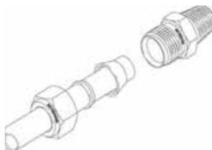
Fig. 3 Orientación de la tuerca y férulas
