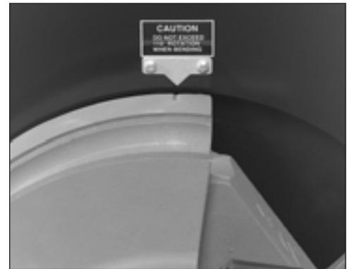
**Figura 6** Muesca de referencia para tubos de 25 y 38 mm (1 y 1-1/2 pulg)
