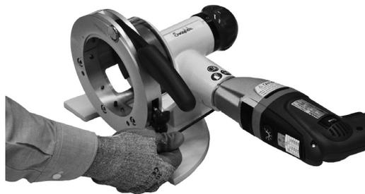
Fig. 16 : Desserrage de la vis de blocage
