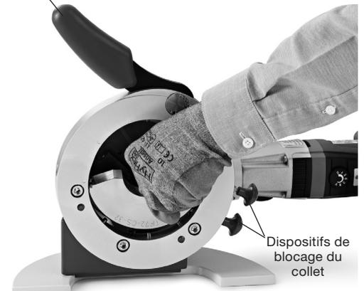
Fig. 9 : Installation du demi-collet inférieur
