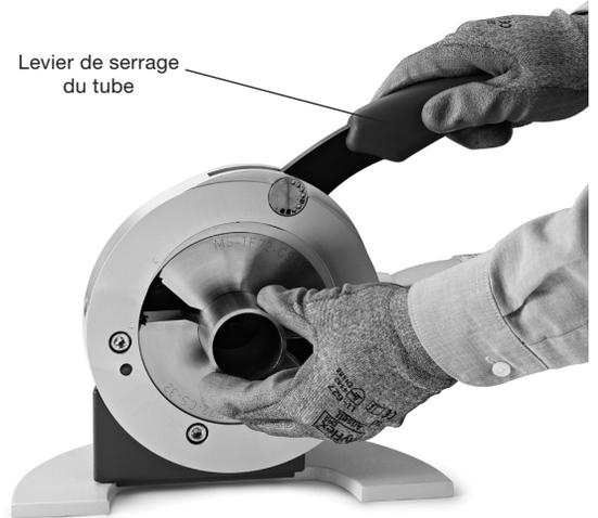
Fig. 14 : Serrage du tube
