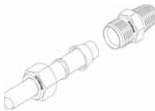
図3：ナットおよびフェルールの向き
