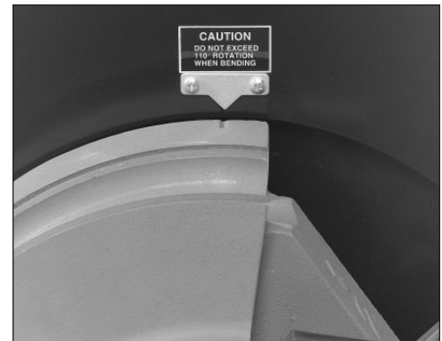
図6 1インチおよび1 1/2インチ、25mmおよび38mm基準ノッチ
