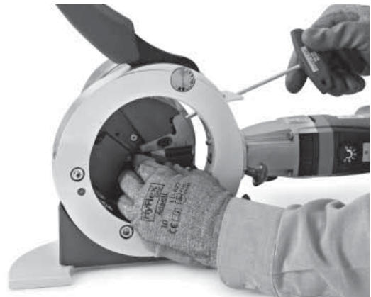
図 7：インサート・ホルダーを取り付ける
