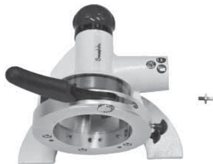
図 19：チューブ・フェーシング・ツールから取り外したナット
