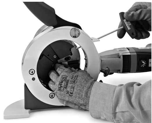
그림 7 공구 홀더 설치
