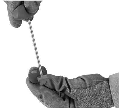
그림 6 절삭 인서트 설치
