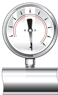
Figura 2. Los picos de presión del sistema generalmente se manifiestan con un puntero doblado. Los picos repentinos provocarán que el puntero salga disparado e impacte contra el pasador, causando el daño.
