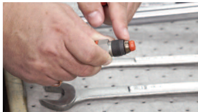
Figura 3. Para facilitar el montaje, el conjunto preensamblado de los racores serie FK incluye una tuerca macho, dos férulas y un eje de plástico extraíble que encaja en el puerto hembra del cuerpo del racor. Imagen ©Swagelok 2021
