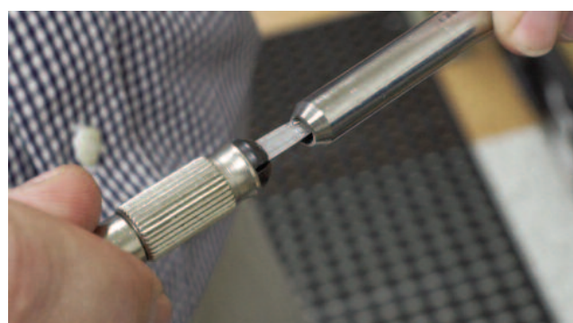
Figura 4. Los accesorios con cono y rosca exigen que los operarios mecanicen manualmente una superficie de cierre cónica (mostrada) y la rosca en ambos extremos del tubo antes de hacer las conexiones. Imagen ©Swagelok 2021
