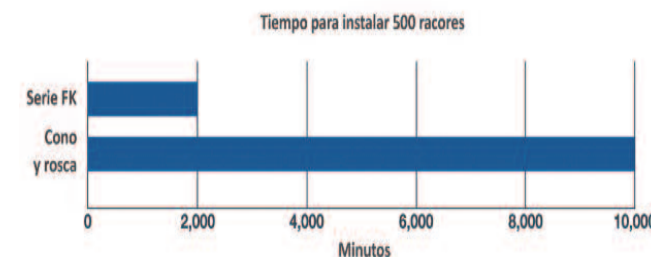
Figura 5. Los instaladores pueden montar los accesorios de compresión serie FK aproximadamente cinco veces más rápido que los accesorios con cono y rosca. Imagen ©Swagelok 2021
