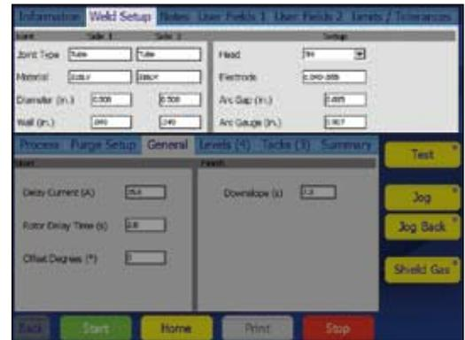
Fig. 22—Weld Setup Tab
