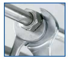
3 Serrez l'écrou manuellement, puis serrez l'écrou d'un demi-tour avec une clé
