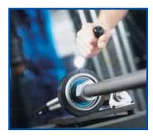
1 Pré-sertissez les bagues sur le tube à l'aide de l'unité de sertissage hydraulique multitête (MSHU) Swagelok
