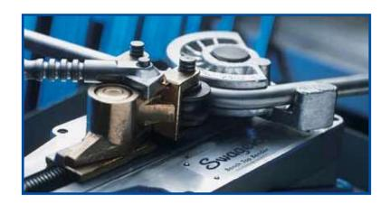
Les cintreuses Swagelok rendent le tracé plus simple. Elles peuvent cintrer des tubes à 180 degrés. Les raccords à 45 et 90 degrés sont remplacés par un tube coudé exactement selon votre besoin. Le tracé peut être plus précis. Les décalages et angles particuliers ne sont plus un problème. Le débit est amélioré et de l'espace est optimisé.
