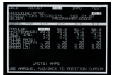
焊接作业屏面
