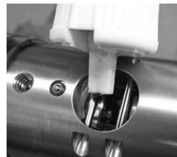
Abb. 35 Schneidflüssigkeit auf das Anfasblatt, den Adapter für manuellen Betrieb und das Rohrende auftragen
