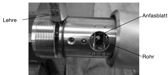
Abb. 20 Sicherstellen, dass das Rohr das Anfasblatt berührt.
