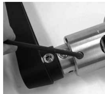
Abb. 3 Lösen der 1/4 Zoll Sicherungsschraube (die zweite Schraube befindet sich auf der anderen Seite des Gehäuses)
