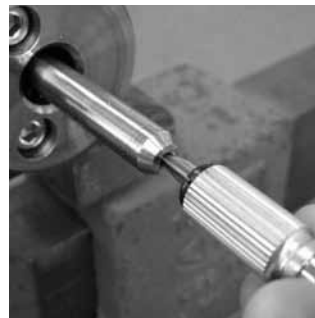
Abb. 37 Entgraten des Rohr-IDs
