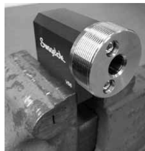
Abb. 17 Den Rohrhalteblock in einen Schraubstock einspannen
