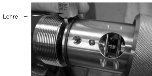
Abb. 19 Verwenden der Anfaslehre zum Feststellen des Abstands
