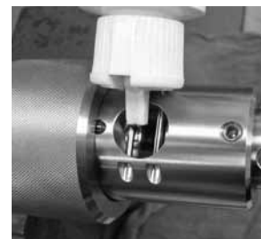
Abb. 23 Auftragen von Schneidflüssigkeit durch das Spanfenster
