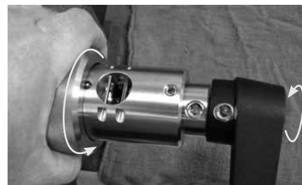
Abb. 25 Lösen der Antriebsmutter
