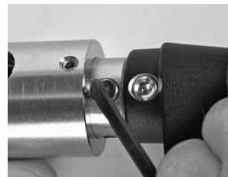
Abb. 27 Lösen der 3/8 Zoll Sicherungsschraube
