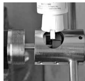
Abb. 39 Auftragen von Schneidflüssigkeit durch das Spanfenster
