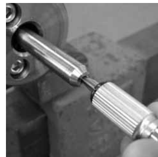
Abb. 26 Entgraten des Rohr-IDs
