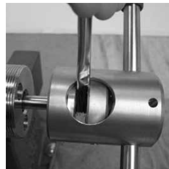
Abb. 41 Entfernen von Gewindeschneidwerkzeug und Spänen
