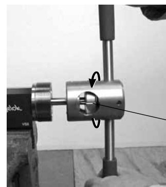
Abb. 40 Vorantreiben des Gewindeschneidwerkzeugs durch Drehen gegen den Uhrzeigersinn
