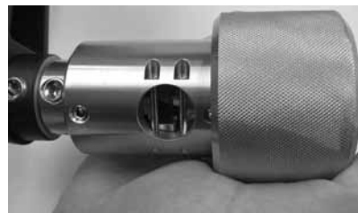
Abb. 22 Zurückstellen der Antriebsmutter
