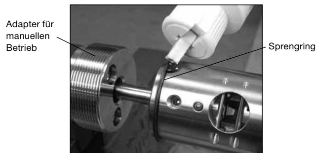
Abb. 21 Schneidflüssigkeit auf den Sprengring auftragen
