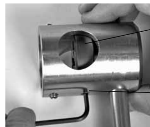
Abb. 14 Lösen der Gewindeschneidkopf-Sicherungsschrauben und Entfernen des Gewindeschneidkopfes
