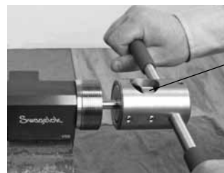
Abb. 38 Schieben des Gewindeschneidwerkzeugs auf das Rohr
