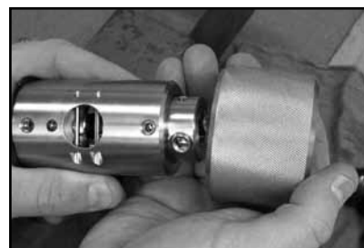
Abb. 29 Entfernen der Antriebsmutter
