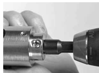
Abb. 31 Einführen des Adapters für Strombetrieb in das Bohrfutter
