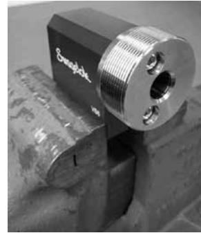
Abb. 32 Den Rohrhalteblock in einen Schraubstock einspannen
