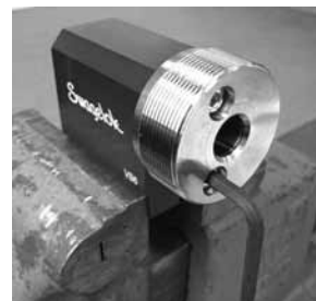
Abb. 2 Entfernen/Anbringen des Adapters für manuellen Betrieb
