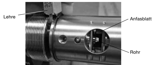
Abb. 34 Sicherstellen, dass das Rohr das Anfasblatt berührt.
