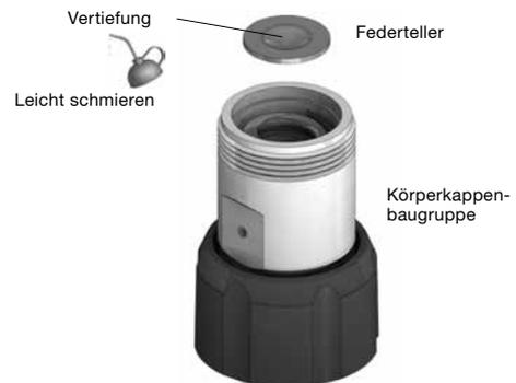
17. Schmieren Sie das **Körpergewinde** und die **Unterseite** der **Körperkappenbaugruppe**.
