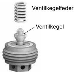
12. Halten Sie die Baugruppe des Sitzhalters auf dem Kopf stehend mit der Ventilkegelfeder oben und schrauben Sie sie in den Körper.
