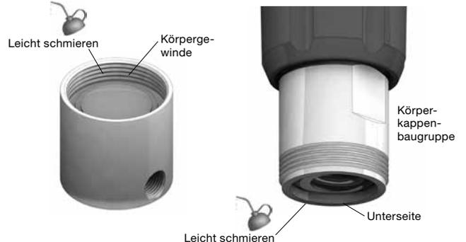
18. Schrauben Sie die Körperkappenbaugruppe auf den Körper. Ziehen Sie mit einem Drehmoment von 33,9 Nm (3,5 mkg, 25 ft·lb) an.
