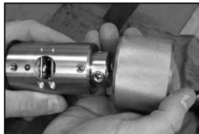
Fig. 29 Desmontar la tuerca impulsora
