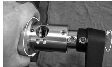
Fig. 25 Aflojar la tuerca impulsora
