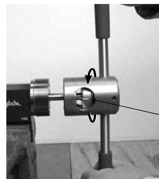
Fig. 40 Avanzar la herramienta de roscado, girando en sentido antihorario
