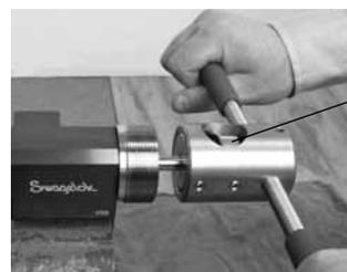
Fig. 38 Instalar la herramienta de roscado en el tubo
