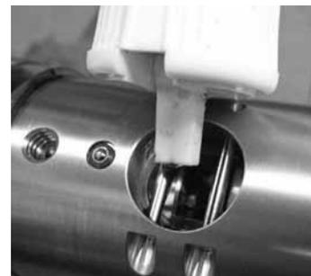
Fig. 35 Aplicar aceite de corte a la cuchilla, al adaptador manual y al extremo del tubo
