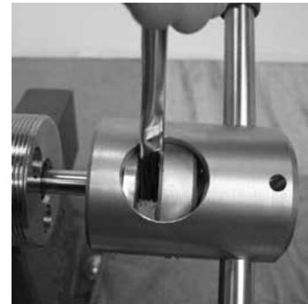
Fig. 41 Desmontar la herramienta de roscado y eliminar las virutas
