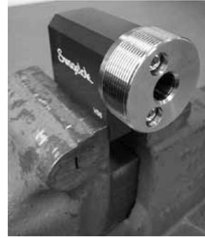
Fig. 32 Instalar el soporte del tubo en un tornillo de banco
