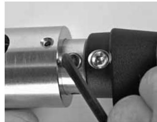
Fig. 27 Aflojar el tornillo de fijación de 3/8 pulg.
