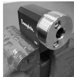
Fig. 17 Instalar el soporte del tubo en un tornillo de banco
