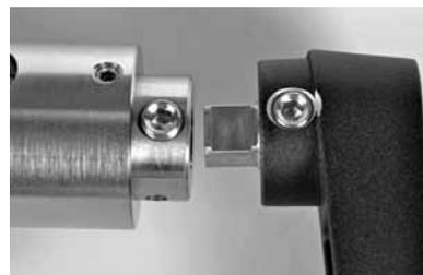
Fig. 28 Desmontar el conjunto del mando
