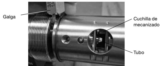
Fig. 34 Verificar que el tubo contacta con la cuchilla de mecanizado
