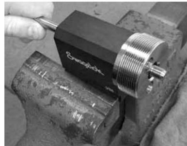
Fig. 42 Desmontar el tubo conificado/roscado del tornillo de banco
