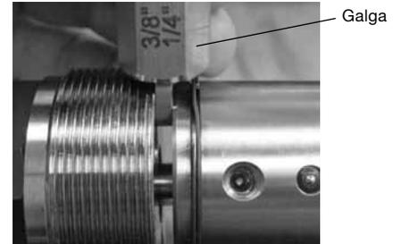
Fig. 33 Fijar la distancia con la galga de conicidad
