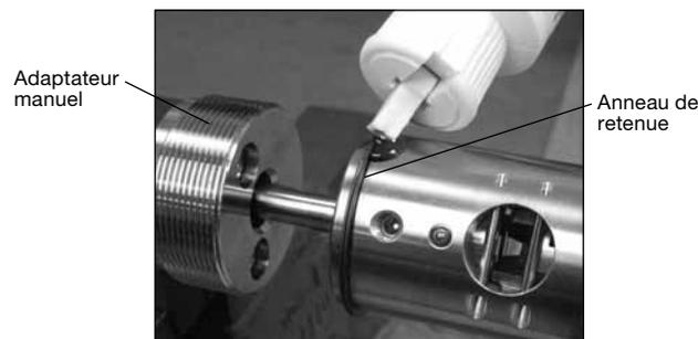
Fig. 21 Appliquer de l'huile de coupe sur l'anneau de retenue
