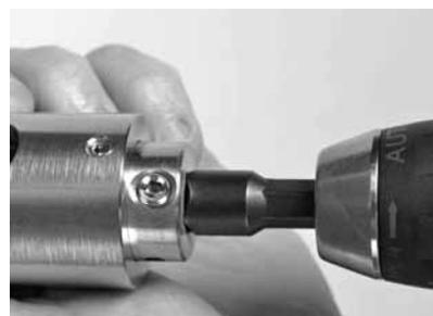
Fig. 31 Introduction de l'adaptateur pour perceuse dans le mandrin
