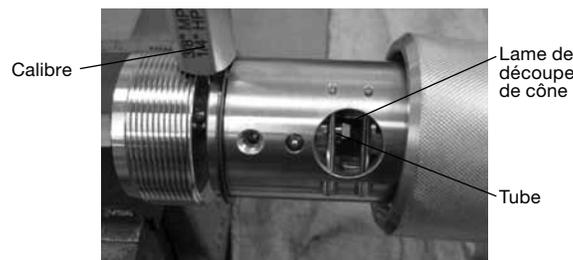
Fig. 20 Vérifier que le tube est en contact avec la lame
