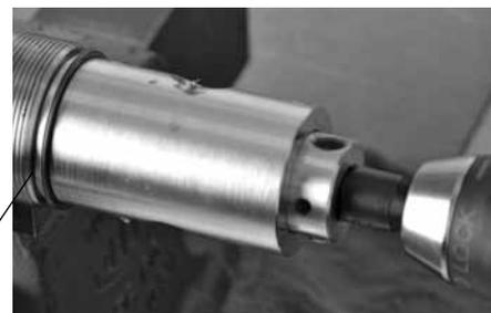
Fig. 36 Faire avancer l'outil à usiner des cônes
