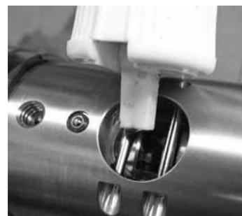
Fig. 35 Appliquer de l'huile de coupe sur la lame, l'adaptateur manuel et l'extrémité du tube
