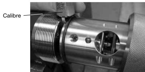
Fig. 19 Utiliser le calibre pour fixer l'espace entre l'adaptateur manuel et l'outil
