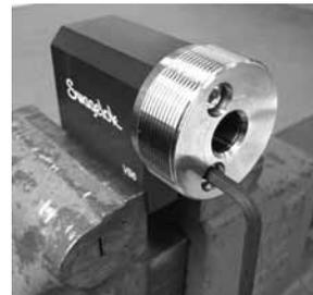
Fig. 2 Démontage/fixation de l'adaptateur manuel
