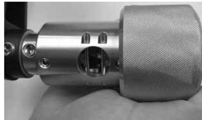
Fig. 22 Remettre l'écrou d'entraînement en place
