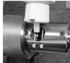
Fig. 23 Appliquer de l'huile de coupe par l'ouverture prévue pour les copeaux
