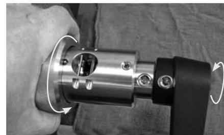
Fig. 25 Desserer l'écrou d'entraînement
