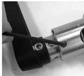
Fig. 3 Desserrer la vis de blocage 1/4 po (la deuxième vis se trouve de l'autre côté du corps de l'outil)
