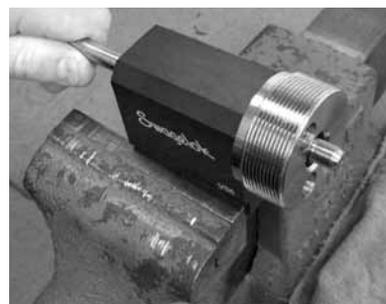
Fig. 42 Retirer le tube usiné/fileté de l'étau
