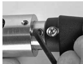
Fig. 27 Desserer la vis de blocage 3/8 po
