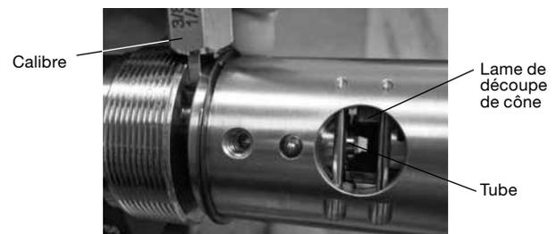
Fig. 34 Vérifier que le tube est en contact avec la lame
