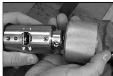
Fig. 29 Retirer l'écrou d'entraînée
