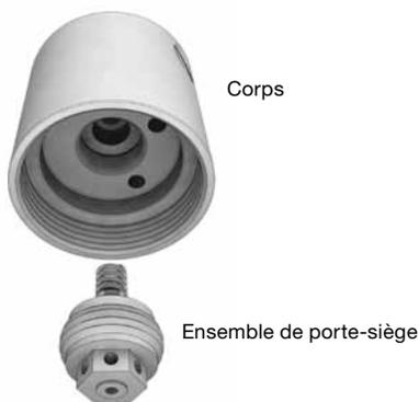
13. Serrez le porte-siège au couple de 15,2 N·m (11,2 ft·lb, 1,6 m·kg).
