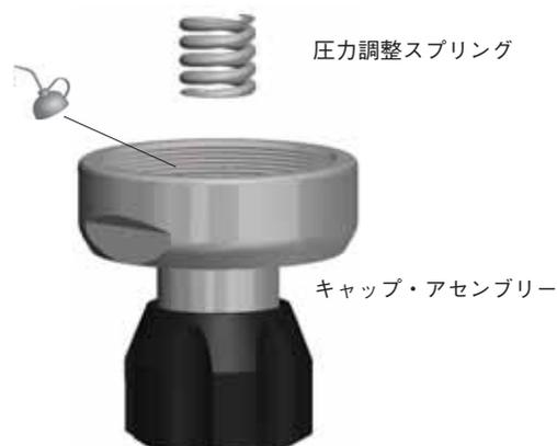
13. キャップ・アセンブリーをボディにねじ込み、キャップ・リングを 240 N・m のトルク値で締め付けます。
