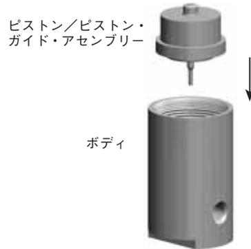
19. 圧力調整スプリングおよび下部スプリング・ボタンをボディ・キャップにセットします。次に、逆さにした状態で、キャップ・アセンブリーをボディにねじ込みます。
