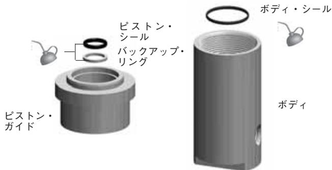
17. ピストン・アセンブリーをピストン・ガイドに差し込みます。ピストン・ガイドをバイスで軽く固定し、ポペット・リテイナーを 10N・m のトルク値で締め付けます。
