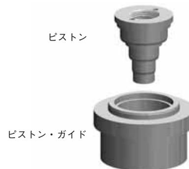
9. ピストン・シールおよびバックアップ・リングをピストン・ガイドから取り外し、次にボディ・シールをボディから取り外します。
