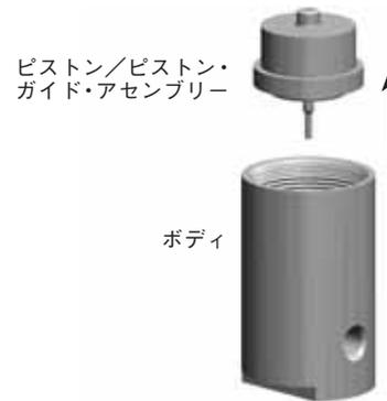
6. ピストン・ガイドをバイスで軽く固定し、ピストン・アセンブリー・バーおよびベント・アセンブリー・リテイナー・ナットを使用して、ポペット・リテイナーをピストン／ピストン・ガイド・アセンブリーから緩めます。ピストン・アセンブリー・バーは、動かさないでください。
