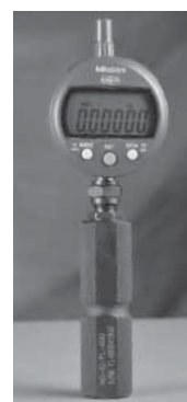
図8：TL ゲージを「0」にプリセットする
