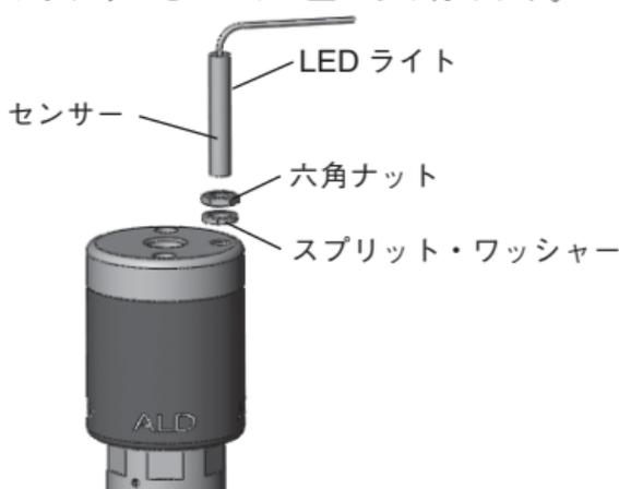
5. センサーをアクチュエータにねじ込みます。センサーを時計回りにまわし、黄色の「ready」LED ライトが点灯したら手を止めます。このライトは閉回路であることを示しています。
