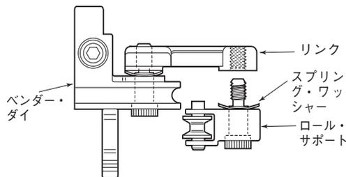
6. ショルダー・ネジをリンクのもう一方のエンドに固定し、レンチで締め付けます。
