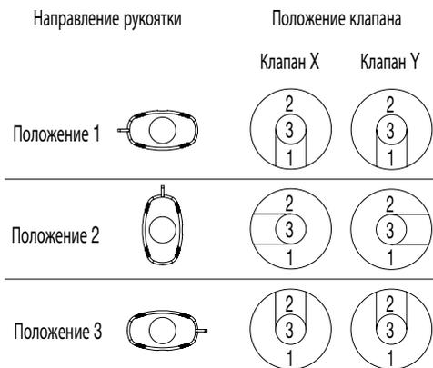
Рис. 7. Схема 2-клапанного узла модуля отбора проб (GSM)
